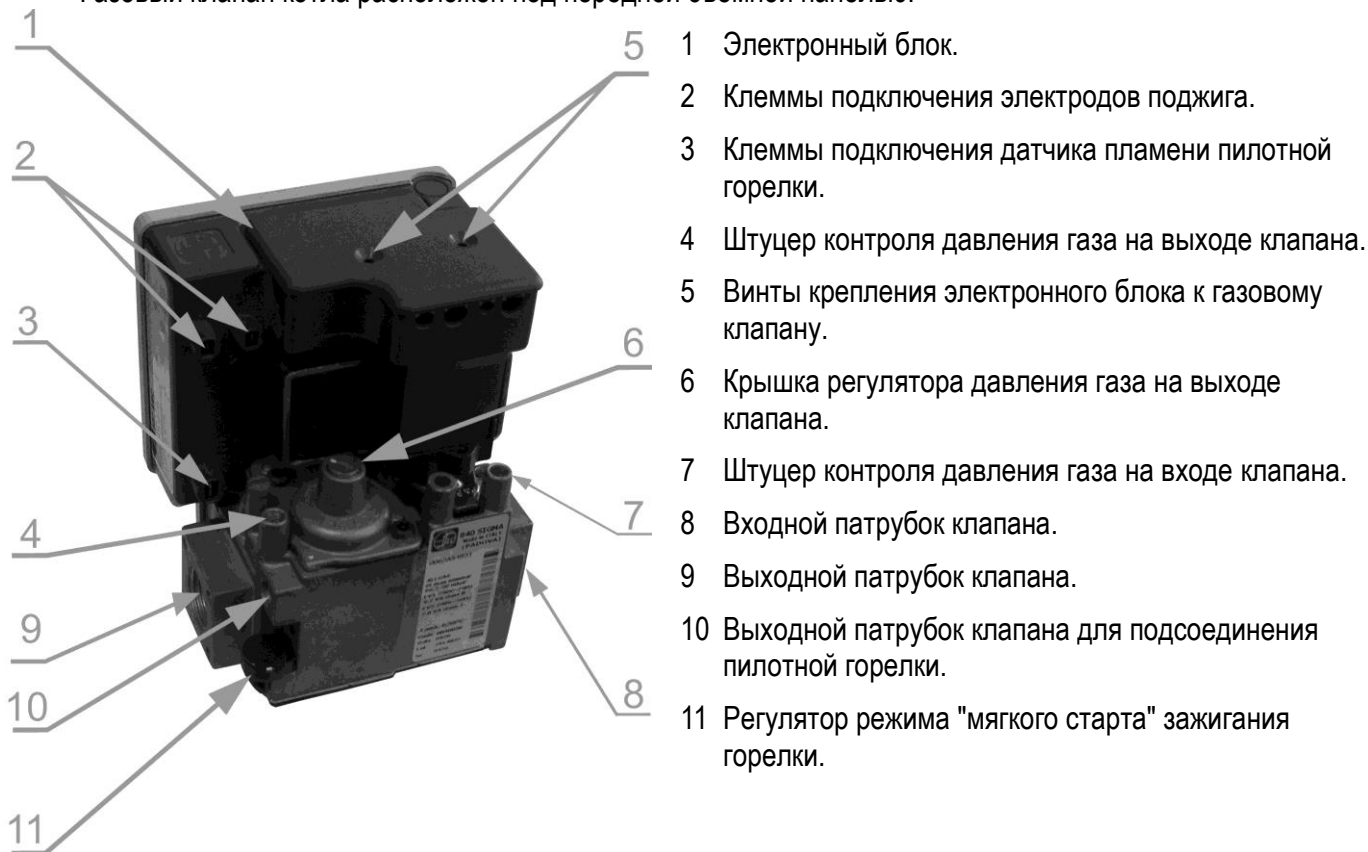
Рисунок 10. Газовый клапан котла с автоматикой.
