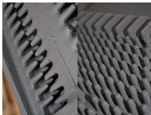
Рисунок 1. Внешний вид поверхностей теплообменника
